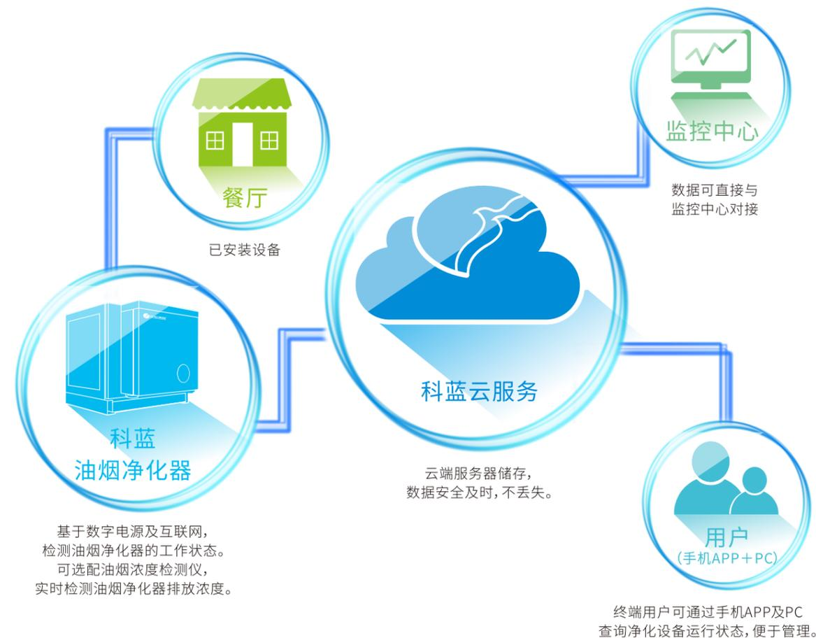
基于数字电源及互联网, 检测油烟净化器的工作状态。可选配油烟浓度检测仪, 实时检测油烟净化器排放浓度。
